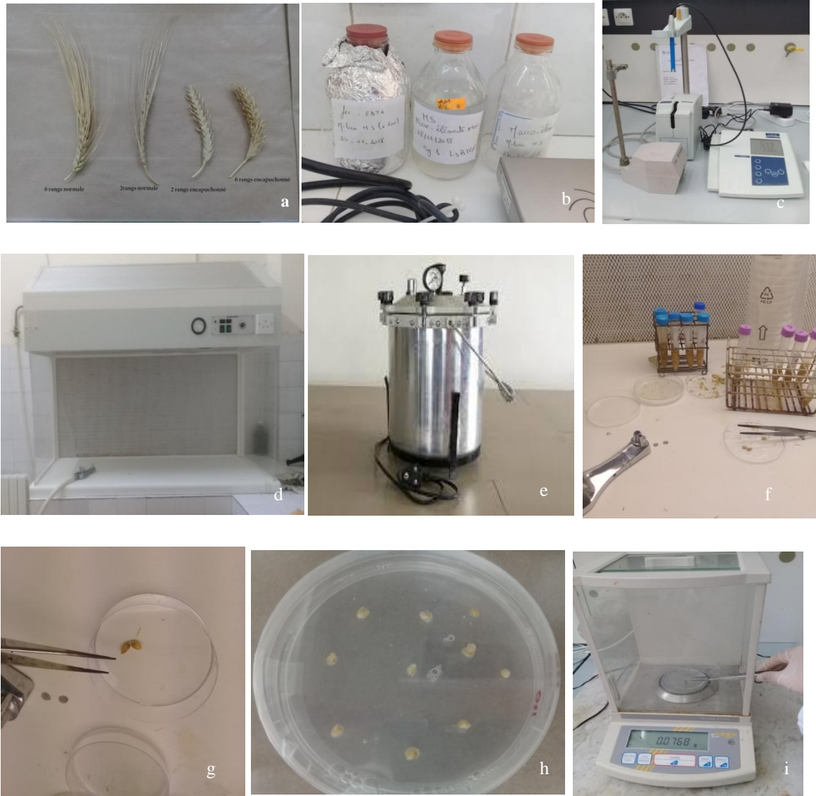
Figure 6 : planche représente le matériel utilisé dans de l'expérience d'induction de la callogénèse : a) les 4 types d'orge de la collection des lignées HD ; b) solutions mères des éléments composant le milieu de culture MS utilisé lors d'induction des cals ; c) pH mètre pour ajuster le pH du milieu nutritif ; d) hotte à flux laminaire utilisé pendant l'expérience ; e) autoclave à pression pour la stérilisation du milieu ; f) organisation du plan de travail lors de l'incision des embryons ; g) extractions des glumelles par la pince pour faciliter l'obtention des embryons ; h) biote de Pétri scellée par le parafilme et marquée après l'ensemencement des embryons sur le milieu de culture MS ; i) balance de précision pour la pesée des cals frais.
